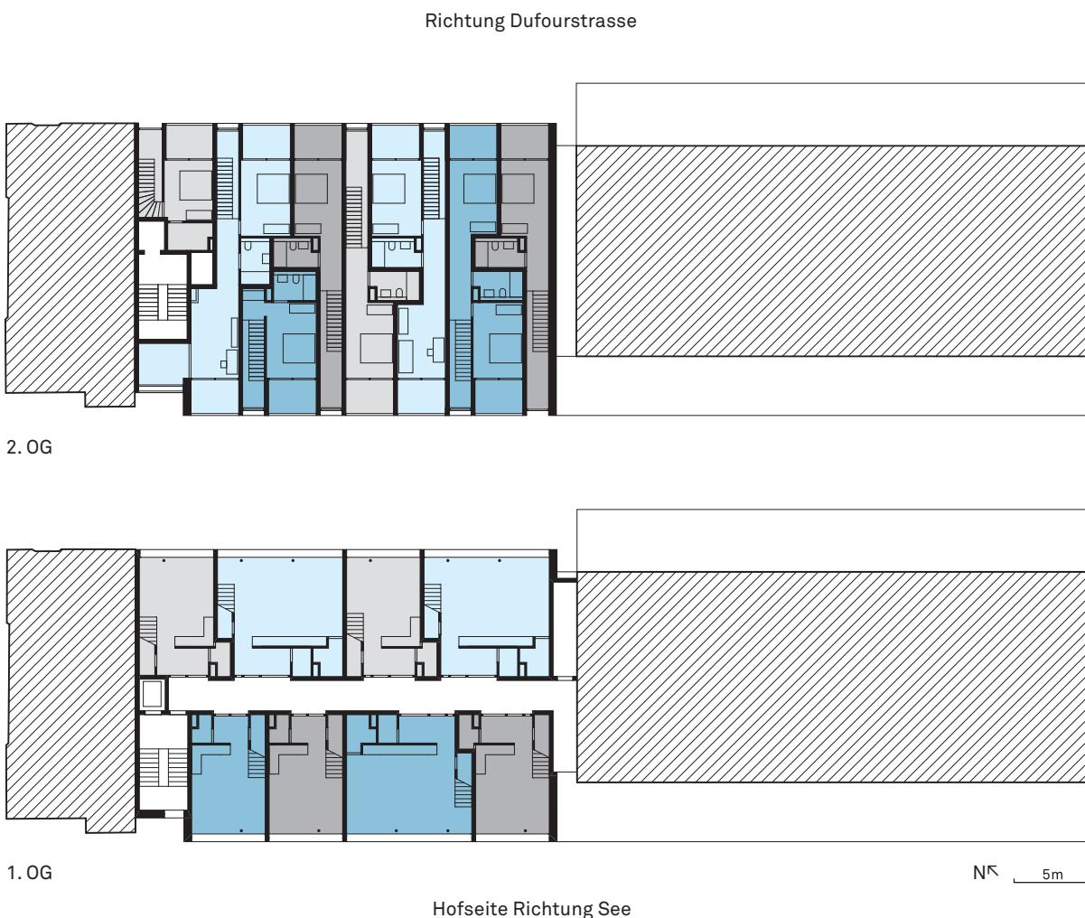
Die einzelnen Wohnzylinder werden durch eine in Gebäudelängsrichtung verlaufende, innenliegende «rue intérieure» vom lateralen Treppenhaus her erschlossen. Durch präzise Lichtführung gelangt das Tageslicht über die Wohnzylinder bis tief in die Gebäudestruktur und gliedert die innere Strasse in atmosphärische Abschnitte.
