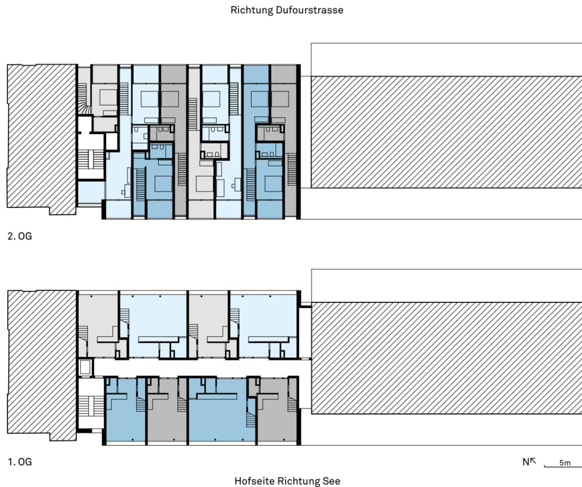
Die einzelnen Wohnzylinder werden durch eine in Gebäudelängsrichtung verlaufende, innenliegende «rue intérieure» vom lateralen Treppenhaus her erschlossen. Durch präzise Lichtführung gelangt das Tageslicht über die Wohnzylinder bis tief in die Gebäudestruktur und gliedert die innere Strasse in atmosphärische Abschnitte.
