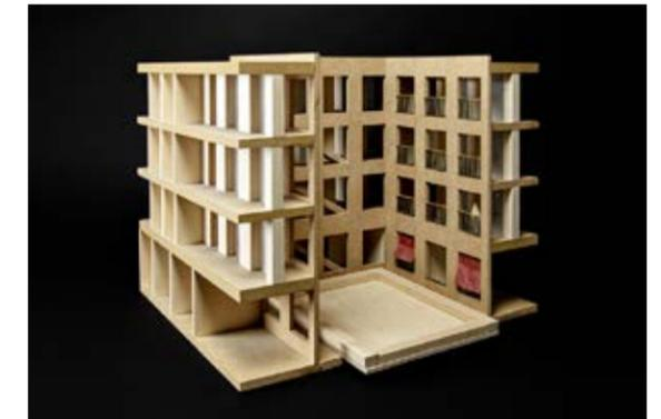
Im Entwurfsprozess sind Modelle ein unersetzliches Arbeitsinstrument, um räumliche Situationen, funktionale Aspekte oder Lichtverhältnisse zu überprüfen. Bei der geplanten Überbauung Centralplatz in Thalwil half das Modell, die Idee eines zentralen Innenhofs mit Laubengängen zu entwickeln.
