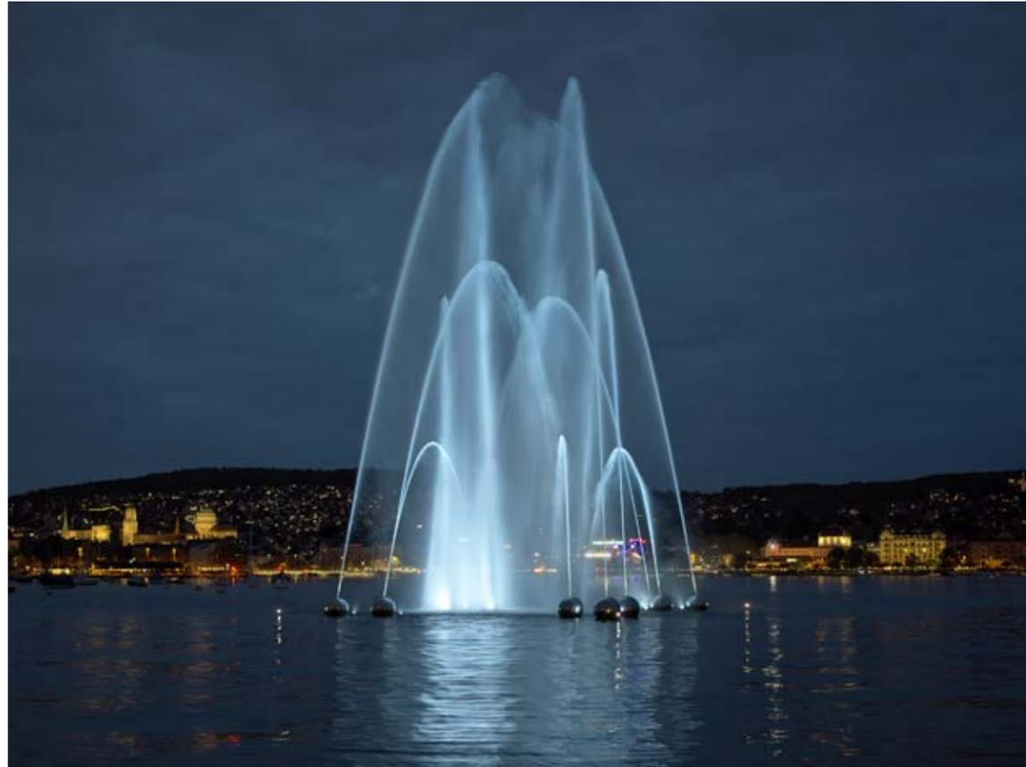
Mit Einbruch der Dunkelheit ergänzt eine gezielte Beleuchtung die Choreografie des Wasserspiels. Dank Spezialleuchten aus dem U-Boot-Bau in den Kugeldüsen phosphoreszieren die laminaren Wasserstrahlen von innen heraus. Gerichtete LED-Scheinwerfer strahlen zusätzlich die höheren Wurfbereiche an, verdeutlichen die Wasserbögen und setzen an Fest- und Feiertagen durch eine Färbung einen besonderen Akzent.
